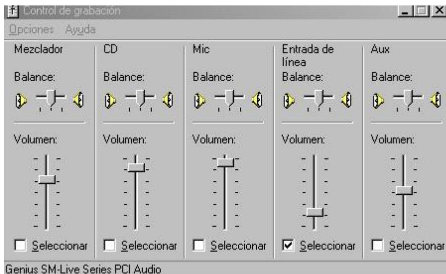
En este panel si verificamos la posición de los cursores veremos que con el de ENTRADA DE LINEA controlamos lo que viene del receptor a la PC y se escucha en los parlantes de la computadora. Más tarde ajustaremos más detenidamente este nivel para no saturar la entrada.
